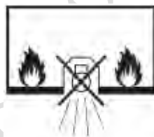
図 1—可燃性の材料表面への直接取付け（埋込み）に適さない [不燃性の材料表面への取付け（埋込み）にだけ適する] 照明器具のシンボル
