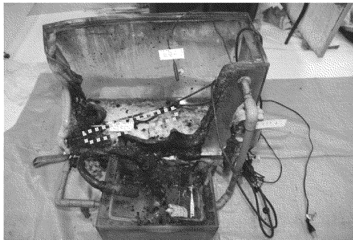
写真8 焼損した水槽等の状況
